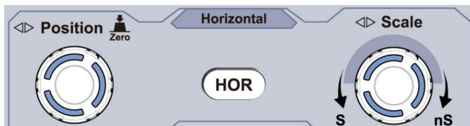
Figuur 3-11 Horizontale controlezone
