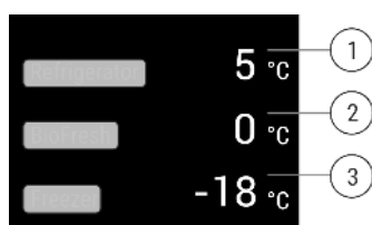
Fig. 9 The status display shows the actual temperature.*
