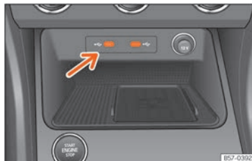
Fig. 155 Centre console: USB input.
