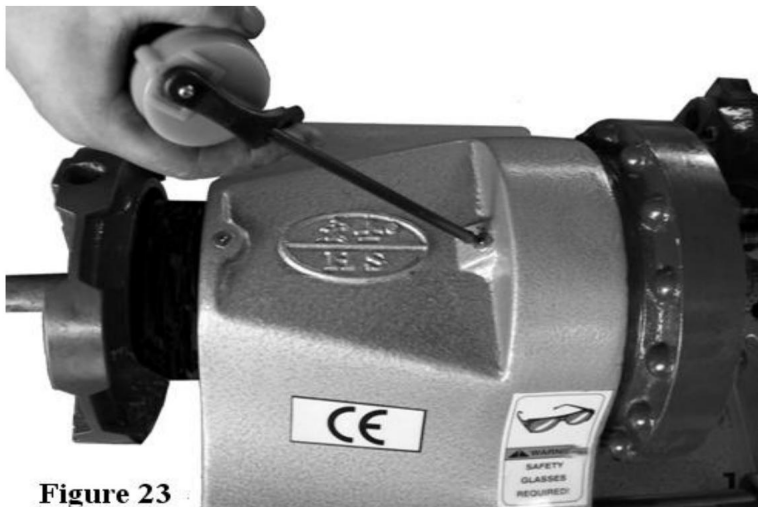
Rysunek 23. Lokalizacja otworów olejowych głowicy
