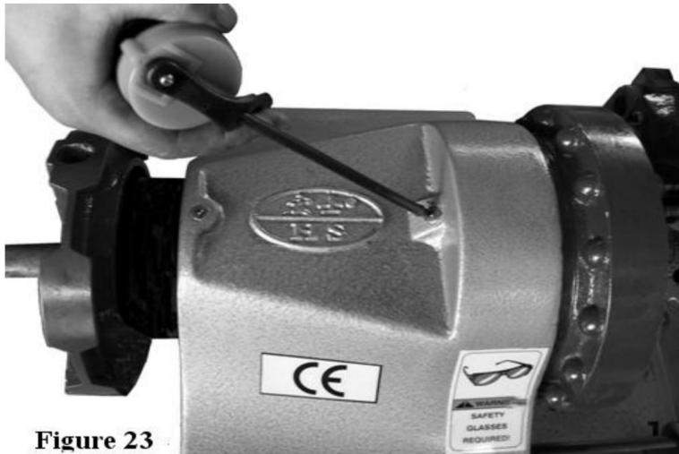
Figura 23. Posizione delle porte dell'olio della testata
