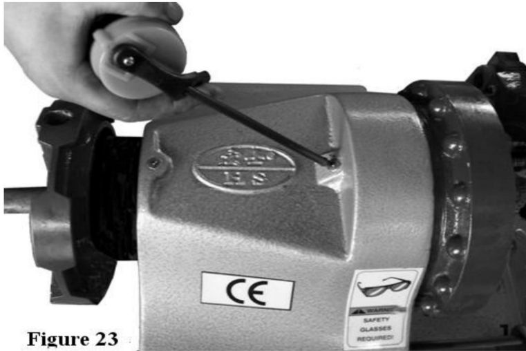
Abbildung 23. Lage der Ölschlüsse am Spindelstock
