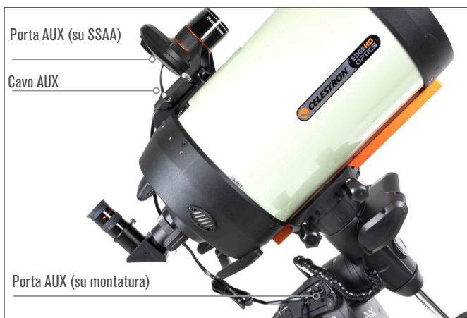
Fig. 10: Utilizzare il cavo AUX fornito per collegare la porta AUX di SSAA alla porta AUX della montatura.
