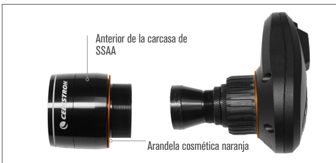
Fig. 6: Para cambiar los soportes, desenrosque por completo y retire toda la parte anterior de la carcasa de SSAA, incluyendo la arandela naranja.
