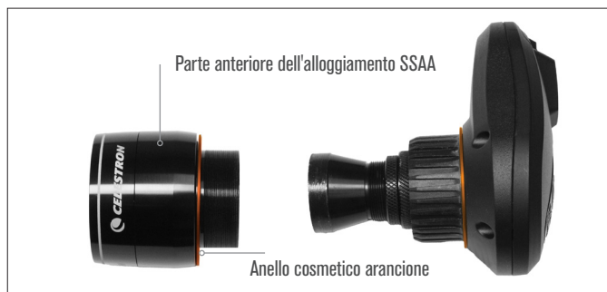
Fig. 6: Per cambiare le staffe, svitare completamente e rimuovere l'intera parte anteriore dell'alloggiamento SSAA, compreso l'anello arancione.
