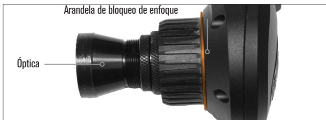
Fig. 24: Afloje la arandela de bloqueo cuando realice ajustes de enfoque, y vuelva a apretar firmemente cuando esté enfocado.
