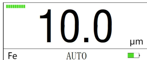
Abbildung 7: Modus „Durchschnitt“ -- Durchschnittsmessung abgeschlossen
