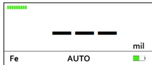
Малюнок 7. Режим усереднення - вимірювання завершено
