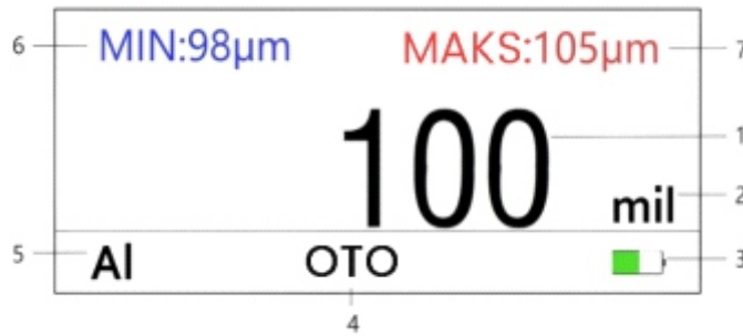
Şekil 16: MIN+MAX Modu Arayüz Görünümü
