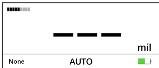
Рисунок 6. Режим усреднения -- процесс измерения
