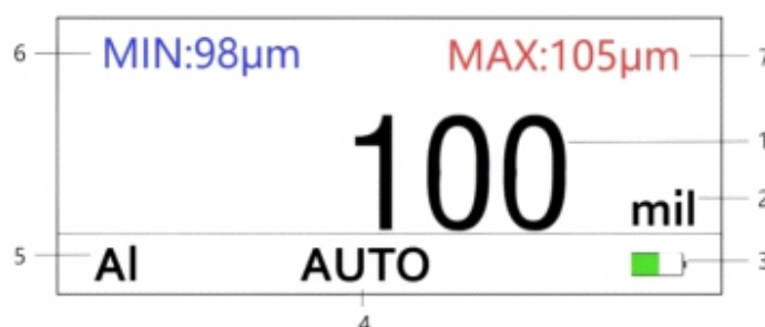
Малюнок 16. Огляд інтерфейсу режиму MIN+MAX
