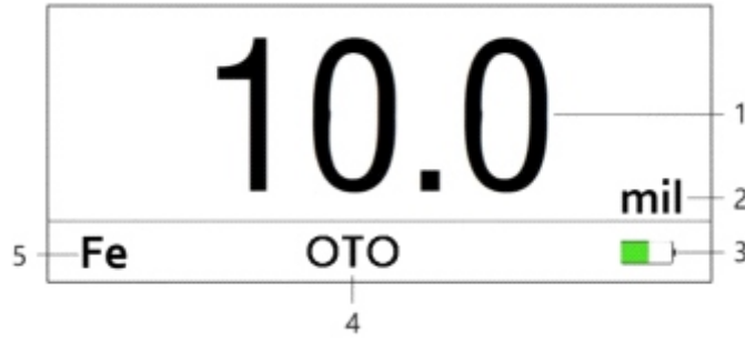
Şekil 15: NORMAL Test Modu Görünümü
