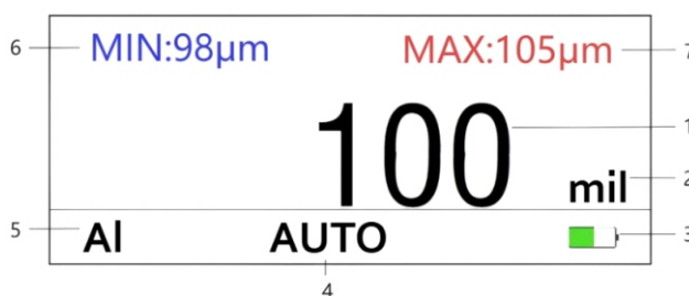
Рисунок 16. Обзор интерфейса режима MIN+MAX
