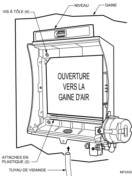
Fig. 5. Installation de l'humidificateur sur une gaine
