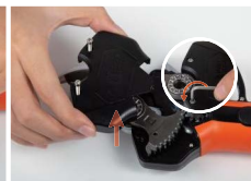
4. Afloje el tornillo de la tapa y retírela.
