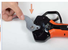
7. Installer la lame inférieure.
