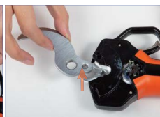
6. Rimuovere la lama inferiore.
