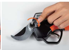
3. Desserrer la grosse vis à l'aide d'une clé dans le sens des aiguilles d'une montre.
