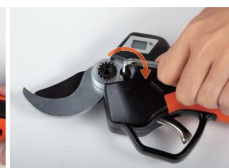
12. Instale el tornillo pequeño.
