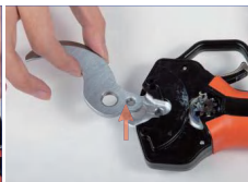
5. Entfernen Sie die obere Klinge und 6. Entfernen Sie die untere Klinge. Swing-Getriebe.
