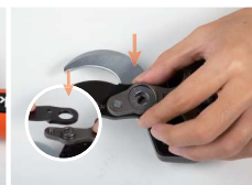
8. Instale la cuchilla superior y el engranaje basculante.
