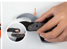
8. Installer la lame supérieure et l'engrenage pivotant.
