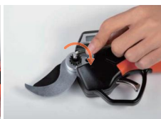
3. Lösen Sie die große Schraube mit Schraubenschlüssel im Uhrzeigersinn.
