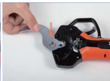
7. Installieren Sie das untere Blatt.
