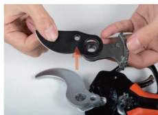
5. Retirer la lame supérieure et le mécanisme de pivotement.
