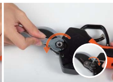
2. Allentare il dado di bloccaggio piccolo in senso orario e togliere la rondella di arresto. Allentare il dado di bloccaggio grande in senso antiorario.
