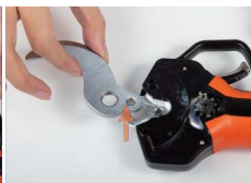
6. Retirer la lame inférieure.
