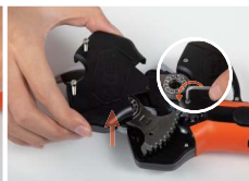
4. Allentare la vite del tappo e rimuoverlo.
