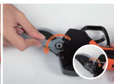
2. Lösen Sie die kleine Sicherungsmutter in einem Im Uhrzeigersinn und heben Sie die Stoppen Sie die Waschmaschine. Lösen Sie die große Verriegelung Mutter gegen den Uhrzeigersinn.
