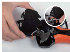
9. Installieren Sie die Kappe.
