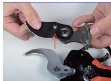
5. Entfernen Sie die obere Klinge und 6. Entfernen Sie die untere Klinge. Swing-Getriebe.
