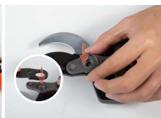
8. Installare la lama superiore e l'ingranaggio di rotazione.
