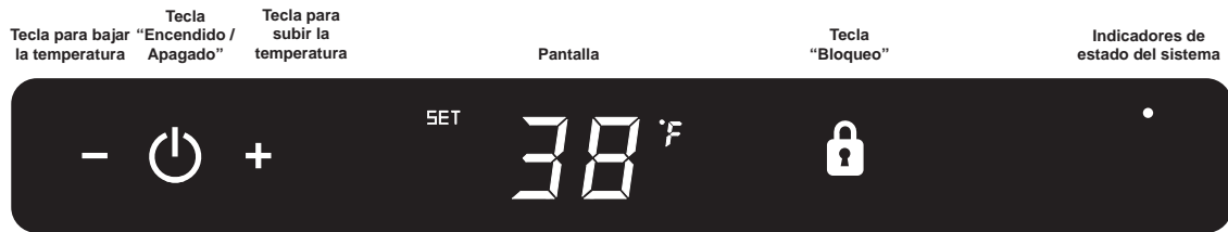
Figura 12 Control electrónico para una sola zona
