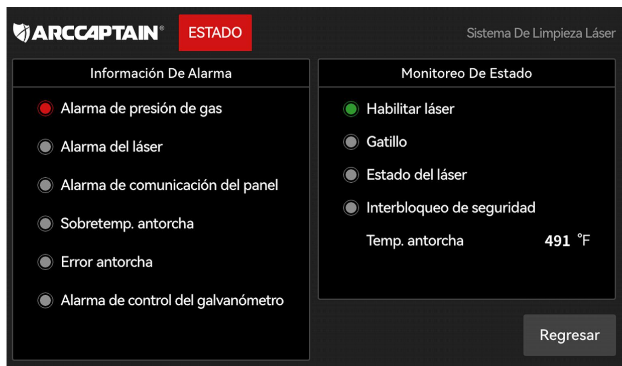
Figura 3-25 Interfaz de estado del sistema de limpieza
