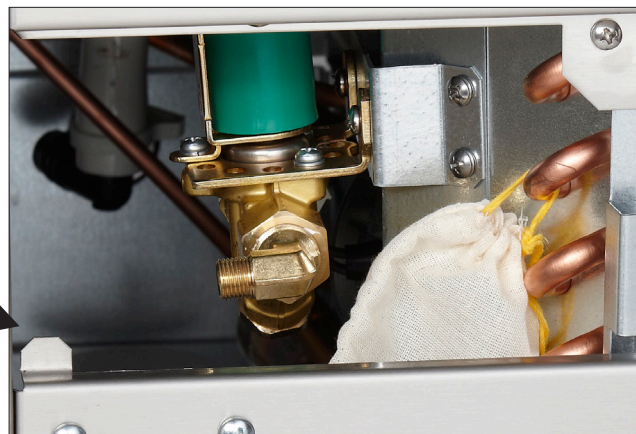
Point de raccordement à l'eau
