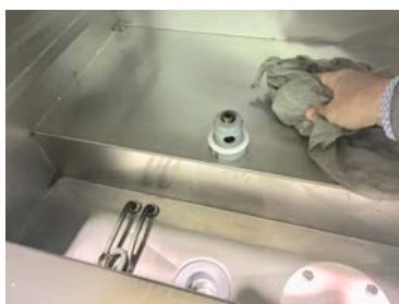
Nettoyez la cuve et vérifiez tous les débris sur le fond .
