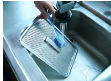
Nettoyez les filtres de la cuve
