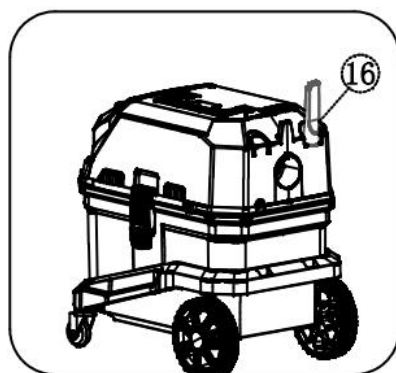
Almacenamiento de accesorios
