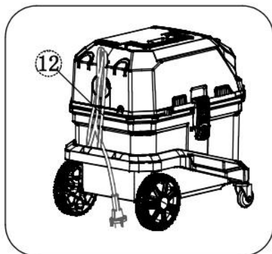
Conservazione dei cavi
