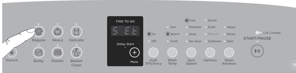
Fig.23 Personnalisation d'un cycle de lavage (par ex. : personnalisation de la température de lavage du cycle REGULAR) (WL4027G)
