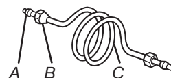
A. Bague de compression C. Tuyau en cuivre B. Écrou de compression
