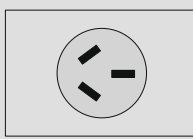
NEMA 10-50R Receptacle (solamente para US)
