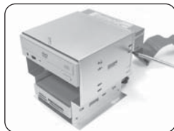
21. 將光碟機固定在光碟機架中 鎖護
