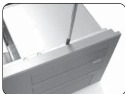
17. 將光碟機架的上固定螺絲鬆開
