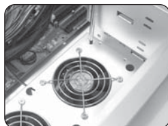
15. 再將風扇架放回機身鎖護固定
