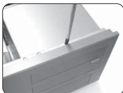
17. 光学ドライブブラケットを固定しているネジを外します
