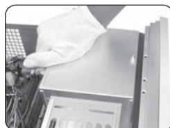
18. まず光学ドライブブラケットを図のように後部パネル側に引きます
