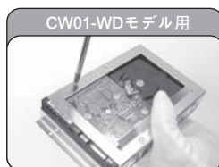
12. Raptor X をブラケットに入れ、ネジで固定します
