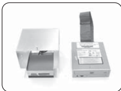
20. 將預裝入光碟機與光碟機架取 出
