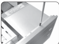
22. 在將光碟機放回機身中，將光碟機架上固定螺絲鎖緊固定
