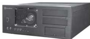
24. 次にサポート支柱を再び取り付ければ、ケースの上部パネルを戻し、図のようにネジ4本で固定します
