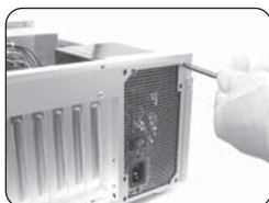
23. 裝入電源供應器
