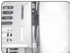
5. 將硬碟架4顆螺絲鬆開
