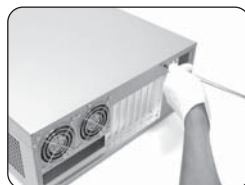
24. 次にサポート支柱を再び取り付ければ、ケースの上部パネルを戻し、図のようにネジ4本で固定します
