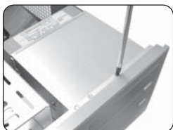
22. 光学ドライブをインストールしたブラケットをケースに戻し、図のようにネジで固定します
